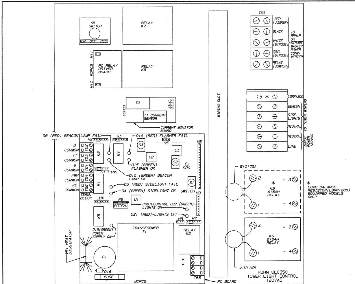
**MODEL ULC350 RED LIGHT CONTROLLER INSTALLATION DETAILS & SPECIFICATIONS**
